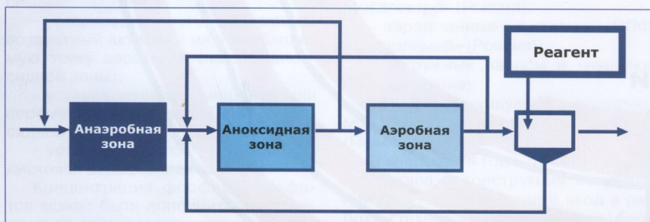
■ Рис. 5. Перспективная технологическая схема биологической очистки сточных вод на НКОС-1
