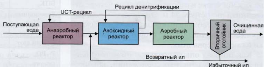
Рис. 2. Технологическая схема биологической очистки сточных вод
