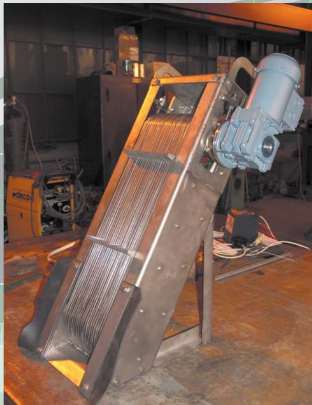
Рис. 4. РЕШЕТКА МОДЕЛИ РВ ТОНКОЙ ОЧИСТКИ. ШИРИНА РЕШЕТКИ 250 ММ, ВЕЛИЧИНА ПРОЗОРА 3 ММ
