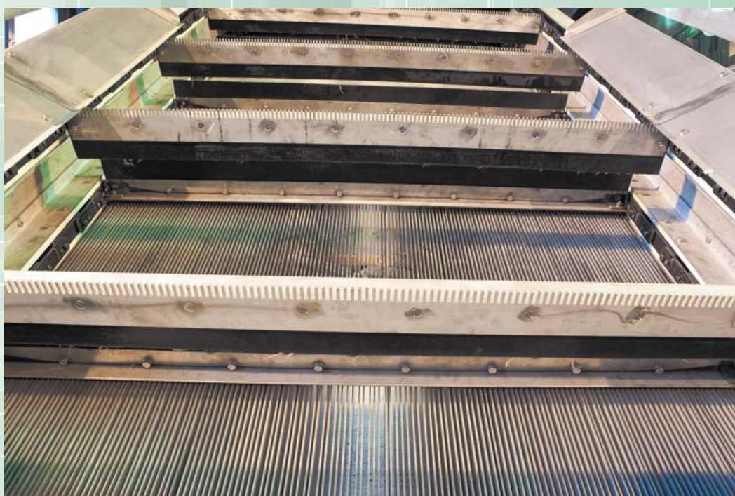
Рис. 2. Фильтровальное полотно решетки РС
